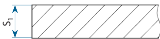
Glatte Dichtfläche Form AA, unbearbeitet oder Dichtleiste Form BB sealing surfaces Form AA, unfinished or Form BB
